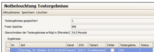
Abb. 11 Parameterfenster Notbeleuchtung Testergebnisse
