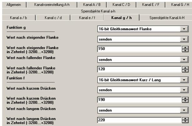
Diese Funktion dient zum Senden von 16-bit Gleitkommawerten (GK-Wert als EIS 5) im Bereich von  $-320,0...+320,0$ , mit einer Nachkommastelle. Der Exponent des 16-bit Gleitkommawertes ist hierbei auf den Wert „4“ fest eingestellt. Es ist einstellbar, ob ein Werttelegramm entweder als Reaktion auf eine steigende und / oder eine fallende Signalfanke an dem Kanaleingang (d.h. beim Drücken und / oder Loslassen eines Tasters z.B.) gesendet werden soll.
