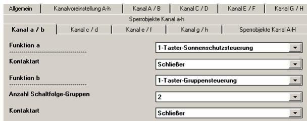
Der Kanal kann für 1-Taster Sonnenschutzsteuerung genutzt werden. Es wird zwischen kurzem und langem Tastendruck unterschieden.
