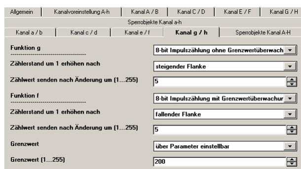
Diese Funktion ermöglicht bei Binäreingängen das Zählen und Speichern von Impulsen als 8-bit Zählwert. Der im Zählwertobjekt gespeicherte Zählwert kann auf eine Anforderung hin und nach Änderung um einen parametrierbaren Differenzwert gesendet werden. Über ein zusätzliches 1-bit-Kommunikationsobjekt kann der Zählwert bei Bedarf per Telegramm auf den Wert 0 zurückgesetzt werden. Über Parameter ist einstellbar, ob
