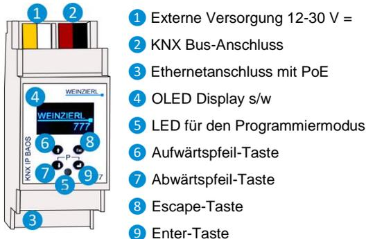
Eine externe Stromversorgung ist nur dann notwendig, wenn das Gerät mit einem Switch verbunden ist, der Power over Ethernet (PoE) nicht unterstützt.
