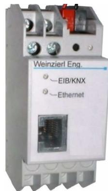
Das Gerät arbeitet nach der KNXnet/IP-Spezifikation unter Verwendung von Core, Device Management und Tunneling.
