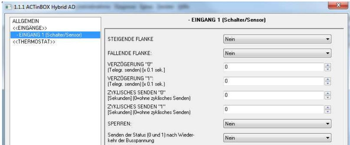
Bild 3.20 Binäreingang Schalter/Sensor
