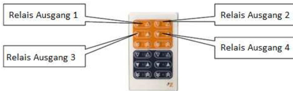
Bild 2.1 Druckbereiche der IR-Fernbedienung
