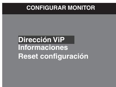
5. Configurar la dirección lógica del monitor principal de la misma vivienda con las teclas  $\uparrow$  y  $\downarrow$ . Desplazarse de una cifra a otra con las teclas  $\odot$  y  $\ominus$ .
