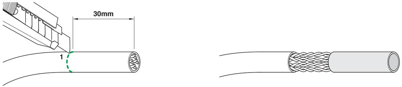
2. Tras quitar la vaina, se ven cuatro pares de hilos enrollados entre sí de dos en dos y de color diferente. Desenrollar los pares de hilos para obtener los ocho hilos separados controlando que se sepan distinguir en caso de que no tengan colores diferentes (en algunos cables, los hilos blanco/color son todos blancos).
