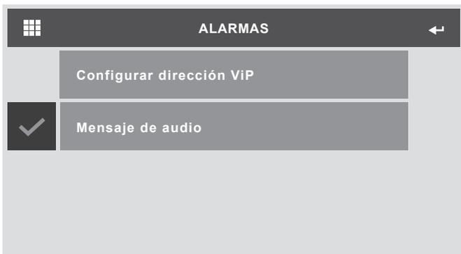
1. Acceder al menú **Configurar Dirección VIP** para programar la dirección del dispositivo al que se llama cuando se efectúa una llamada de tipo alarma
