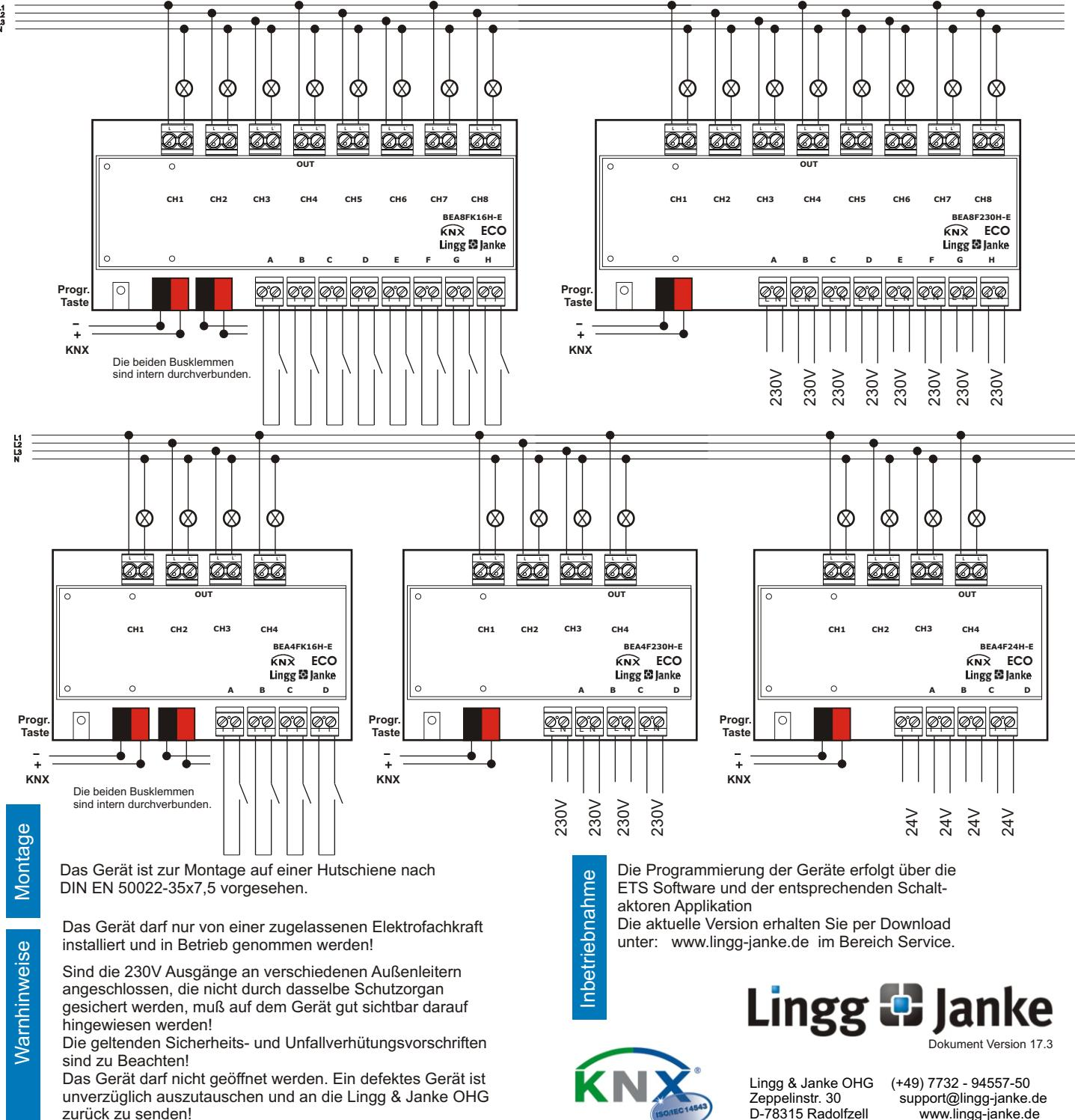
Das Gerät ist zur Montage auf einer Hutschiene nach DIN EN 50022-35x7,5 vorgesehen.
