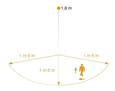
Mögliche Montagehöhe: 1,80 m – 2,00 m Orange: radial und tangential 3 skallerbare Achsen
