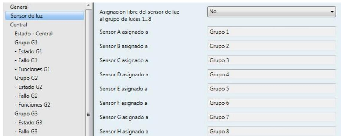
Si se asignan varios sensores de luz a una salida debe determinarse el valor de sensor que debe utilizarse como valor real (tamaño de entrada) para el circuito regulador.
