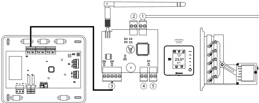
Para la conexión de más de 10 módulos, es necesaria una fuente externa, AZX6POWER. Estos valores pueden verse afectados en función de la distancia entre ellos.
