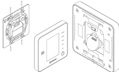
**Nota:** N'oubliez pas de retirer le système anti-vandalisme avant de retirer le thermostat du mur.
