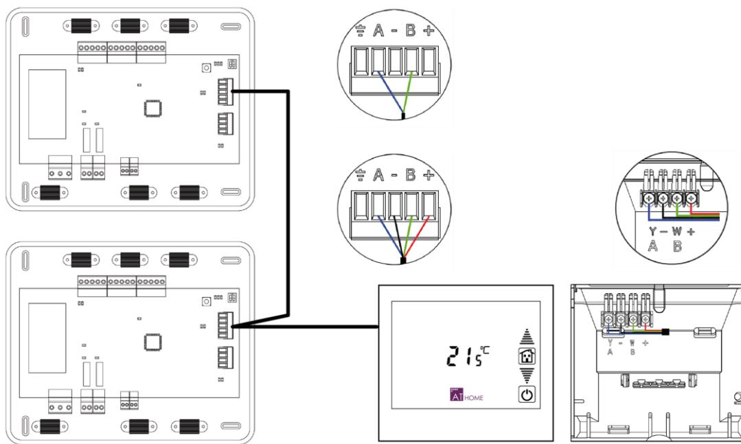
Dans le cas du Supermaître en saillie, connectez les fils du câble bus aux picots situés à l'arrière de l'interface grâce aux vis prévues à cet effet, tout en respectant le code couleur indiqué.
