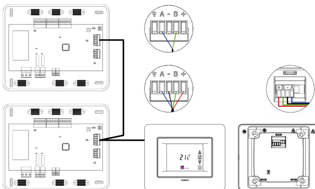
Dans le cas du Supermaître encastré, connectez les fils du câble bus au bornier 5 pins situé **à l'arrière de l'interface** grâce aux vis prévues à cet effet, tout en respectant le code couleur indiqué.
