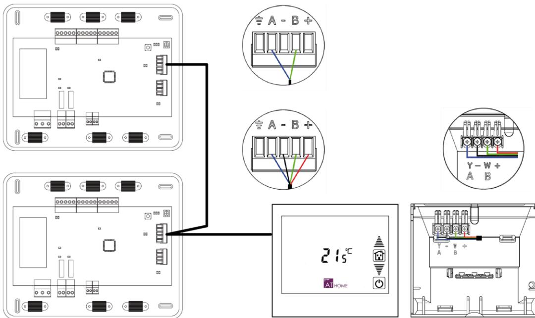
Il Supermaestro a superficie dispone di una apposita morsettiera ubicata nell'alloggiamento del termostato. Fissa i fili con le viti rispettando il codice di colori associato.
