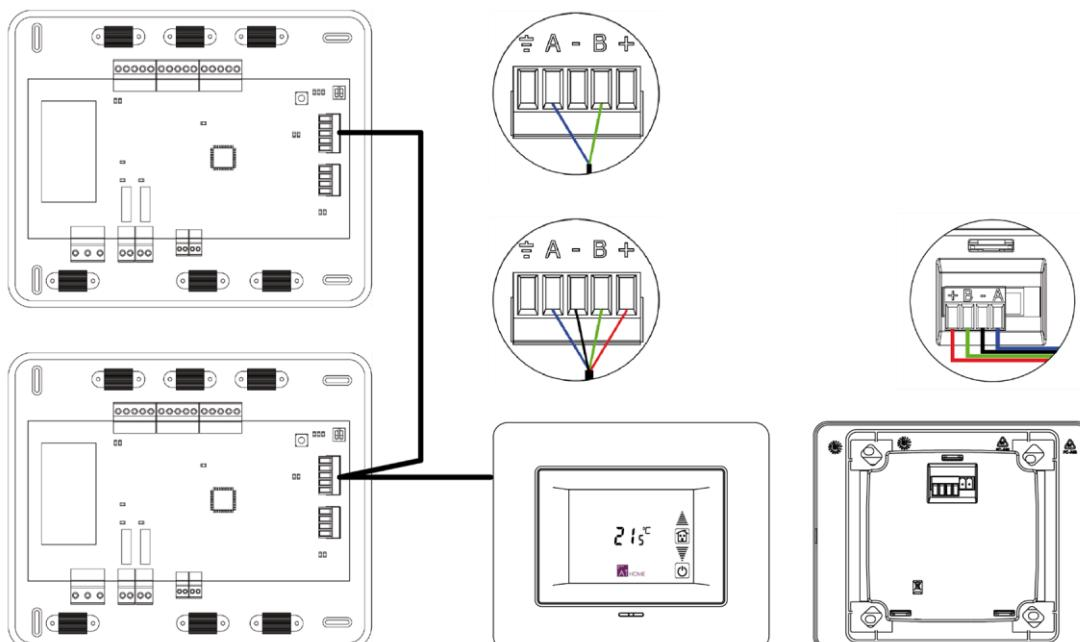
Nel caso di un Supermaestro ad incasso, il termostato dispone di un morsetto a 5 poli ubicato nella parte posteriore dello stesso termostato. Fissa i fili con le vite del morsetto rispettando il codice di colori associato.
