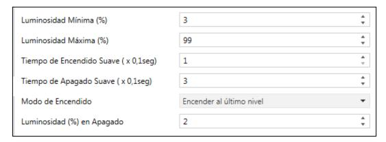
Luminosidad Mínima (%): define el mínimo nivel de luminosidad que se permite alcanzar a la hora de regular. Este valor debe ser lo suficientemente alto como para evitar posibles parpadeos de las luminarias en valores de regulación bajos. Aunque se reciban valores de regulación inferiores, el Actuador no bajará de este valor, solamente se podrá apagar.
