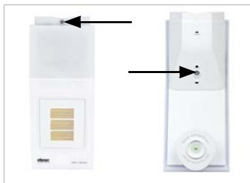
Fig. 6 Suelte los dos tornillos en la tapa (arriba) y la parte inferior (abajo) con un destornillador de estrella.
