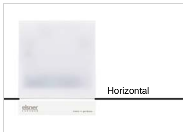
Fig. 2 El aparato se debe montar horizontalmente en la posición transversal.
