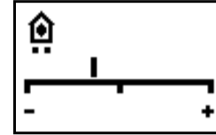
Fig. 5 Indicación de modo con indicación analógica para cambiar el valor teórico básico. En el ajuste del regulador de la figura se ve "Valor teórico básico reducido".
