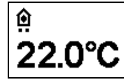
Fig. 4 Indicación de modo con valor teórico actual o valor teórico básico
