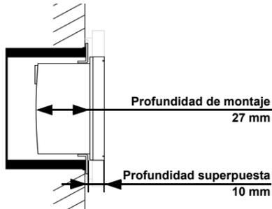
Fig. 2: Dibujo de sección.
