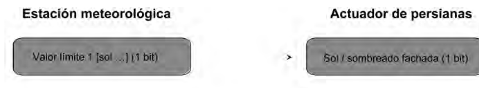
Figura 26: Configuración de los objetos de comunicación para el ejemplo de aplicación I.
