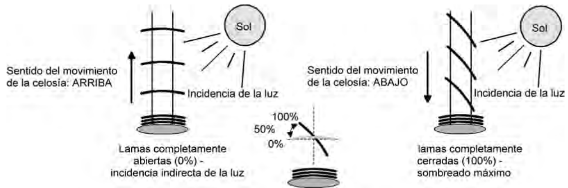
Figura 14: Tipo 2 – Celosías con posición de lamas oblicua y recta
