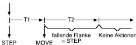
Si dentro de T1 no se detecta flanco de bajada, al pasar ese tiempo se envía un telegrama de accionamiento largo, y comienza el tiempo T2, que es el de regulación de lamas. Si se detecta el flanco descendente dentro de T2, entonces se envía un telegrama de accionamiento corto. Esta función se utiliza si hay persianas que solamente permiten ajuste de lamas, y T2 debe ser el tiempo que tardan las mismas en girar los 180°.
