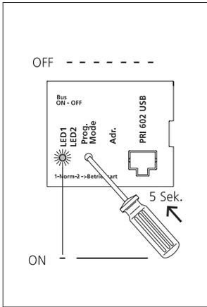
**1** Activar el modo Plug+Play en el BNG/BVNG 650-..., mantener pulsada durante 5 segundos la tecla Prog.-Mode, tras lo cual el LED 1 se ilumina permanentemente.
