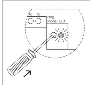
**2** Cambiar el BSE 650-... al modo de programación. Pulsar para ello la tecla del modo de programación con un pequeño destornillador. El LED parpadea lentamente.
