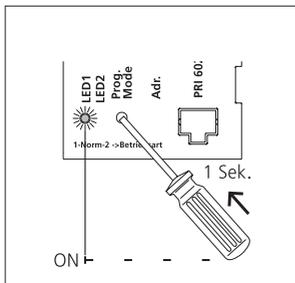
Poner la fuente de alimentación para bus en el modo de programación con un pequeño destornillador a través del orificio de la cubierta.
