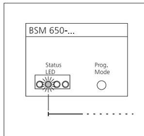
**3** Seleccionar el relé correspondiente, activar para ello con un destornillador la tecla del modo de programación en el BSM 650-... hasta que se encienda el LED deseado (LED 2 = relé 2, pulsar dos veces).
