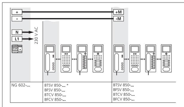
Puede alimentarse como máximo 1 BTSV/BFSV/BTCV/BFCV 850-... con una fuente de alimentación NG 602-... La corriente máxima de la tensión continua de 24 V DC del NG 602-... es de 300 mA. Si deben sonar varios teléfonos de bus al mismo tiempo a través de un botón de timbre, cada BTSV/BFSV/BTCV/BFCV 850-... debe tener su propia NG 602-... Pueden alimentarse hasta 3 teléfonos de bus con monitor color desde una fuente de alimentación de vídeo VNG 602-...
