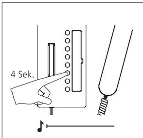
**4** Pulsar la tecla que debe programarse, mantener pulsada durante 4 segundos. En el auricular se escucha un tono de confirmación constante. El contacto de conmutación del BSE 650-... se cierra durante 1 segundo.
