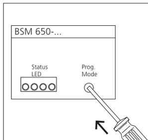
**2** Cambiar el BSM 650-... al modo de programación. Pulsar para ello brevemente la tecla del modo de programación con un pequeño destornillador. El LED 1 se enciende y parpadea lentamente tras aprox. 3 segundos.
