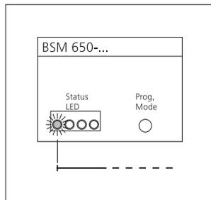
**3** Seleccionar el relé correspondiente, activar para ello con un destornillador la tecla del modo de programación en el BSM 650-... hasta que se encienda el LED deseado (LED 1= relé 1).
