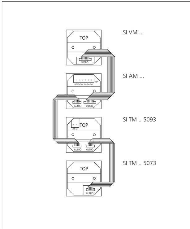
Cada módulo se monta en una caja de conexiones empotrada conforme a DIN 49073. Se recomienda el montaje en una caja profunda. El montaje se realiza con los anillos de fijación adjuntos.
