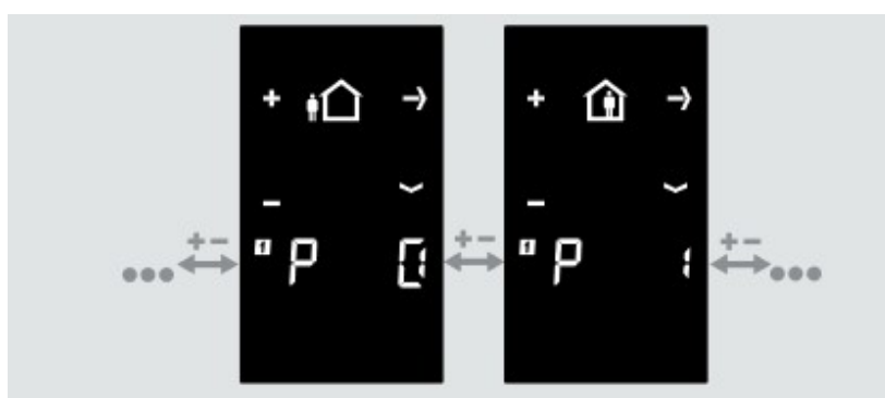
13. Activación del modo de presencia en el RCD 1
