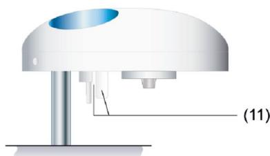
Figura 3: Colocación de las alitas de plástico para evitar turbulencias
