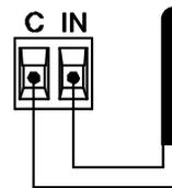
ZAC-NTC68S/E/F puede ser conectado a cualquier dispositivo Zennio con entradas tipo sonda de temperatura
