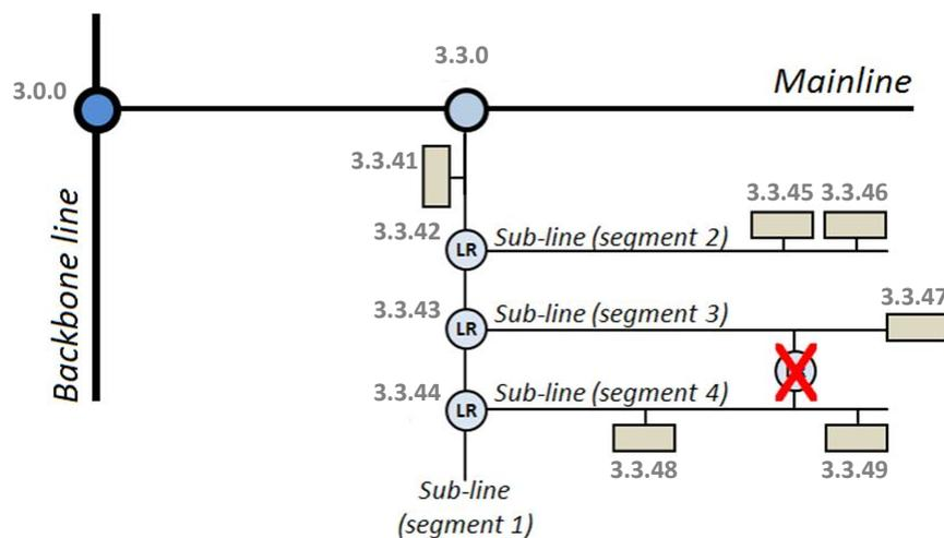
Figura 7 Situación no permitida: segmentos con dos conexiones al bus
