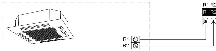
Figura 2: Cableado de KLIC-PA al equipo de climatización
