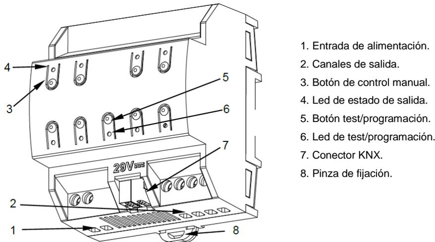
Figura 3 Diagrama de elementos.
