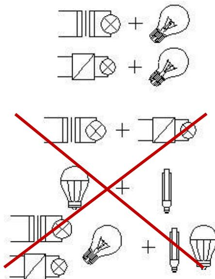
Figura 2 Combinación de tipos de carga.
