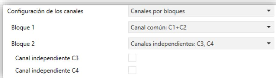
Figura 5 Configuración de canales por bloques en NarrowDIM X4.
