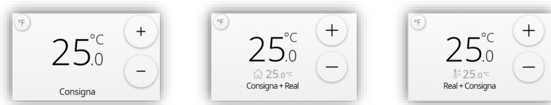
Figura 94. Temperatura de consigna con diferentes tipos de indicador
