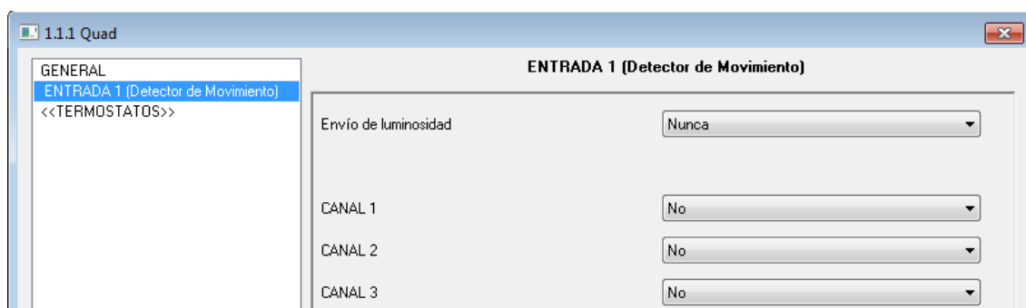
Figura 4.1. Configuración entrada como detector de movimiento
